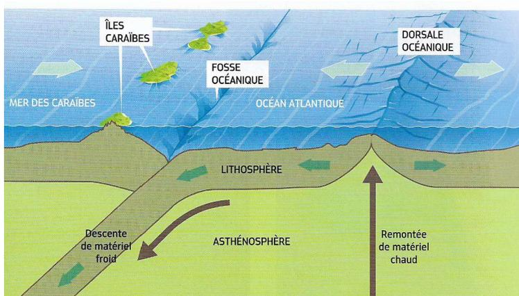
**La relation entre la tectonique des plaques et la dissipation de l'énergie thermique interne de la Terre.** Au niveau d'une zone de subduction, la lithosphère froide plonge dans l'asthénosphère. En conséquence, au niveau d'une dorsale, deux plaques s'écartent. Cette divergence est associée à une remontée de matériel chaud, permettant la dissipation de l'énergie thermique. La Terre présente donc une **dynamique** interne.
