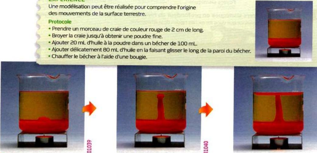
**Modèle pour comprendre les conséquences d'une remontée de matériel chaud, en profondeur de la Terre.** L'huile rouge, chauffée, remonte vers la surface puis se refroidit. Cette remontée met en mouvement la surface du liquide.
