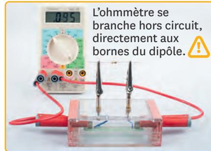
L'ohmmètre se branche hors circuit, directement aux bornes du dipôle. ⚠
