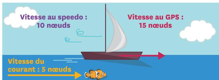
**Doc. 2** Mesure de la vitesse au speedo et au GPS.
