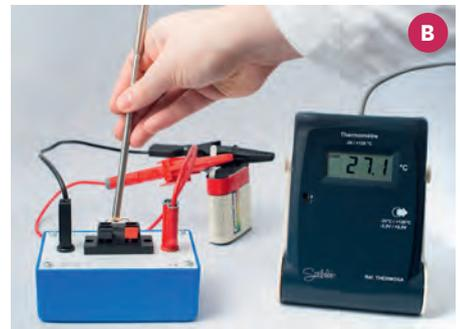
**Doc. 3** Mesure de la température d'un résistor avant (A) et après (B) quelques minutes de circulation du courant électrique.
